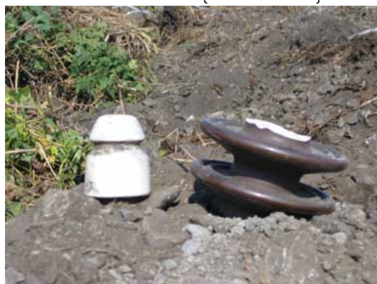
Isolátory. Levý sloužil pravděpodobně telefonu. Pravý, když byl ještě celý, visel ze sloupu trolejového vedení. {28.9.2006}
