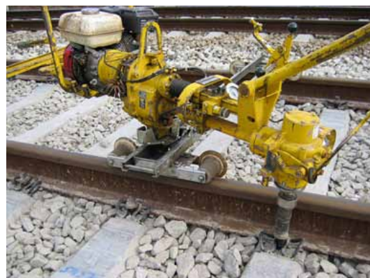
Motorová zatáčečka je stroj, který uvolňuje nebo utahuje upevňovač kolejnic. {18.11.2006}
